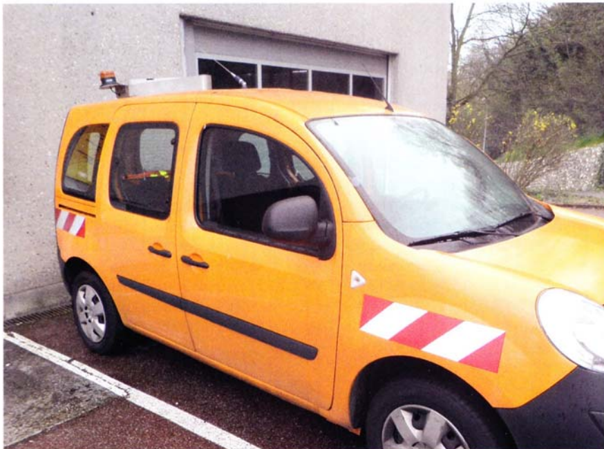
En 40 MHz, les antennes sont longues donc inclinées pour passer sous les trémies et tunnels = performances dégradées.
